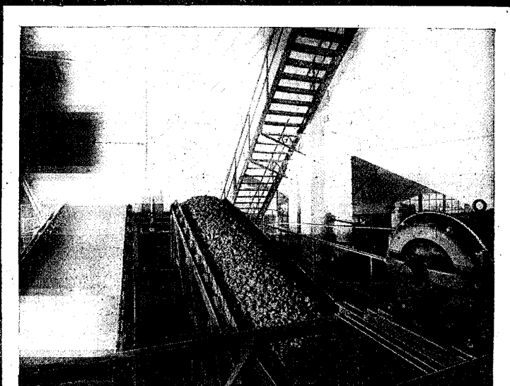
Transporteurs à charbon dans une importante Usine à Gaz Débit horaire : 30 tonnes
