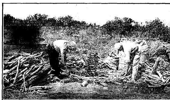
Fig. B. — Mise en place du bois (2<sup>e</sup> phase).
