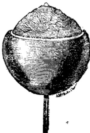
Le diamant à polir et à facetter est scellé à l'alliage d'étain et de plomb dans une coquille de cuivre maintenue dans une tenaille en acier; cette tenaille, chargée d'un poids, presse le diamant sur la meule pendant sa rotation (fig. 117).
